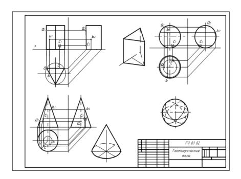
Лист 1.3. Выполнить сечение геометрического тела плоскостью, найти натуральную величину сечения, построить развертку поверхности
